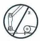
Non insistere sullo stesso punto. Non battere sullo stesso punto per più di 30 secondi consecutivi; se non si riesce a rompere in questo tempo cambiare posizione in parallelo cercando di rompere una sezione più piccola. Così facendo si evita il surriscaldarsi della punta e per induzione tutto il demolitore.
