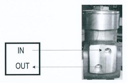
Il tubo flessibile al demolitore viene collegato attraverso nipples.
