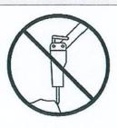
Colpo a vuoto. Particolare attenzione va fatta a non effettuare colpi a vuoto. Un colpo a vuoto può determinare rotture ai tiranti che tengono serrati i vari componenti del demolitore, ai fermautensili e all'utensile. Quindi staccare l'alimentazione al martello al momento esatto della rottura della roccia
